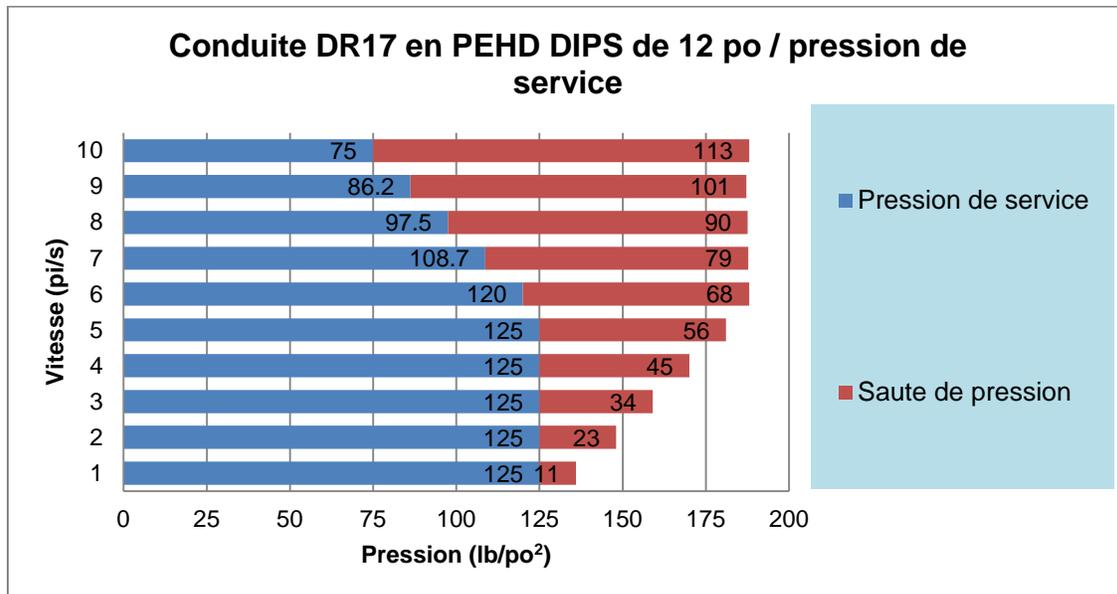
Dans une conduite DR17 en PEHD de 12 po, interrompre un écoulement d'une vitesse de 5 pi/s peut causer une saute de pression de 56 lb/po<sup>2</sup>. Comme la saute de pression prévue de 56 lb/po<sup>2</sup> est inférieure au jeu de 62,5 lb/po<sup>2</sup>, la pression de service tolérée de 125 lb/po<sup>2</sup> n'a pas à être réduite.
