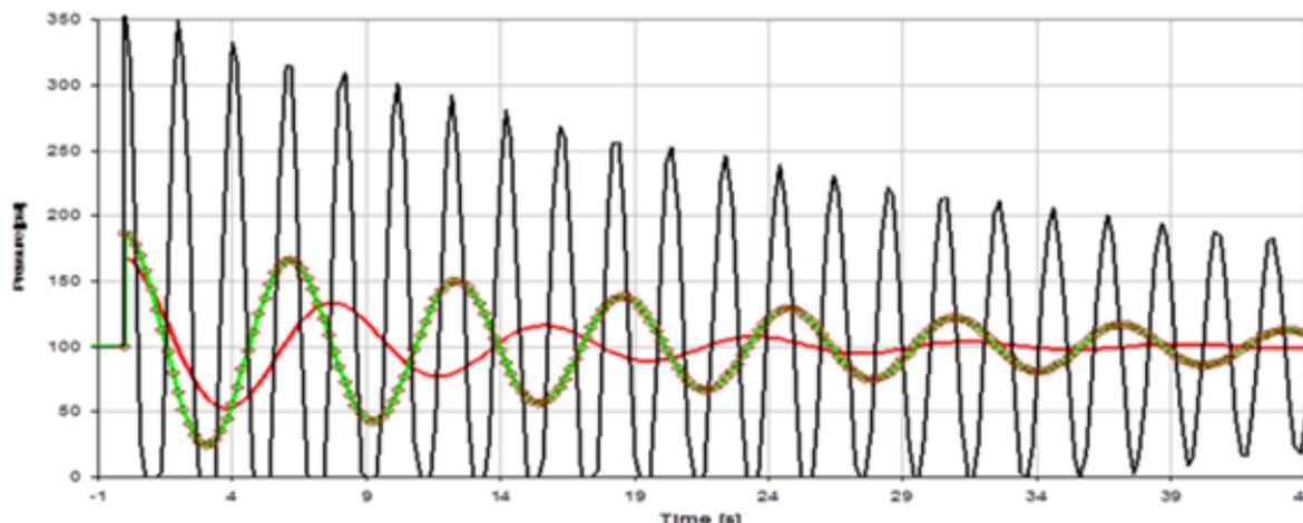
Étant donné les variations dynamiques de la vitesse d'écoulement, le profil de pression d'une conduite dépend énormément du matériau; il est donc presque impossible de retrouver « la même » classe de pression sur des conduites de matériaux différents. Comme la capacité à supporter des pressions causées par des événements dynamiques varie d'un matériau à l'autre, la classe de pression ne peut servir de critère de sélection à elle seule.
