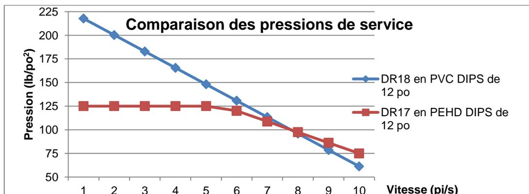
Lorsque la vitesse prévue est inférieure à 5,5 pi/s, la pression de service est égale à la classe de pression du PEHD (125 lb/po<sup>2</sup>). Mais lorsque la vitesse prévue est supérieure à 5,5 pi/s, la pression de service est inférieure à la classe de pression du PEHD.
