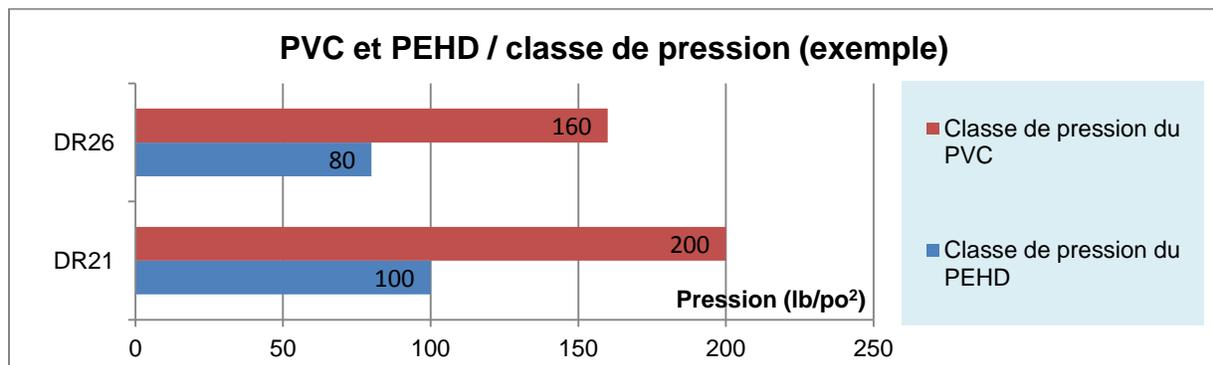
Le concepteur ne peut pas choisir le type de conduite ou de matériau en se fiant uniquement à la classe de pression recommandée pour l'application. Il doit aussi tenir compte des variations de pression du réseau occasionnées par des événements comme le démarrage ou l'arrêt d'une pompe, et l'ouverture ou la fermeture des vannes.
