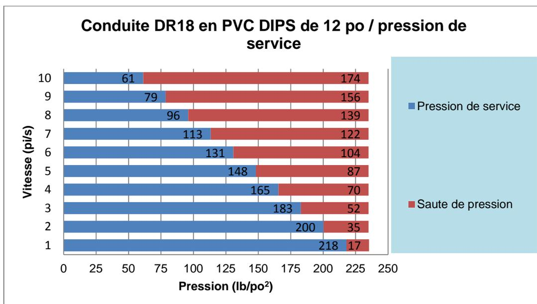
Dans une conduite DR18 en PVC de 12 po, interrompre un écoulement d'une vitesse de 5 pi/s peut causer une saute de pression de 87 lb/po<sup>2</sup>. La pression de service de la conduite en PVC ne doit donc pas dépasser 148 lb/po<sup>2</sup> (235 lb/po<sup>2</sup> – 87 lb/po<sup>2</sup> = 148 lb/po<sup>2</sup>).
